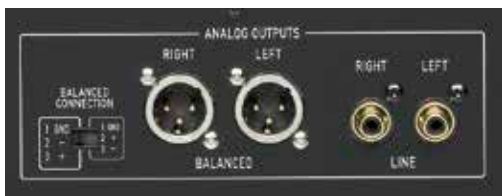
▲ Analog geht's per XLR- oder Cinch-Buchsen raus. Erstere lassen sich in der Belegung umschalten.
