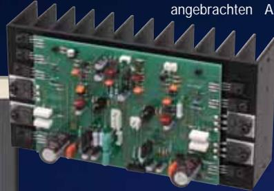
Die Bauteile jeder Endstufe des E-350 sind gemeinsam auf eine kompakte Platine montiert. Metallrippen führen ihre Wärme ab
