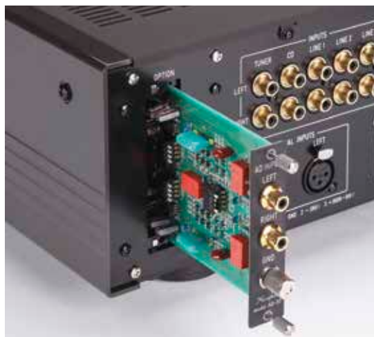
Die für MM- und MC-Abtaster geeignete Phono-Karte AD-30 verschwindet in einem Schacht auf der Rückseite (l.). Zwischen den Tonabnehmertypen schaltet man auf der Frontplatte um (o.). Neben dem D/A-Modul DAC-40 ist an dieser Stelle auch ein weiterer Line-Eingang möglich (um 160 Euro).
