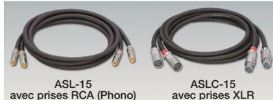
•Type : configuration hybride multiple à 8 conducteurs •Conducteurs centraux : conducteur en cuivre à haute pureté (7N) + 3 types de conducteurs en cuivre •Gaine : PVC marron foncé, diamètre 8,7 mm •Diélectrique : polyéthylène •Résistance CC en boucle totale : 20 milliohms/m •Capacité entre deux conducteurs centraux : 378 pF/m •Résistance isolation : 40 Mohms/km
