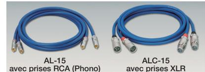
•Type : câble blindé 2 conducteurs •Conducteurs centraux : [câble en cuivre désoxygéné + câble en cuivre plaqué argent] •Gaine : PVC bleu, diamètre 8,0 mm •Diélectrique : polyéthylène + polyéthylène moulu externe •Résistance CC en boucle totale : 33 milliohms/m •Capacité entre électrodes : 170 pF/m •Résistance isolation : 40 Mohms/km
