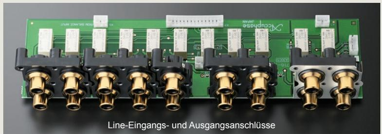
Line-Eingangs- und Ausgangsanschlüsse
