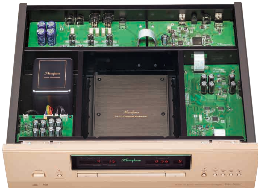
▲ An insgesamt vier Viskose-Dämpfern ist das Laufwerk schwingungshemmend aufgehängt.
