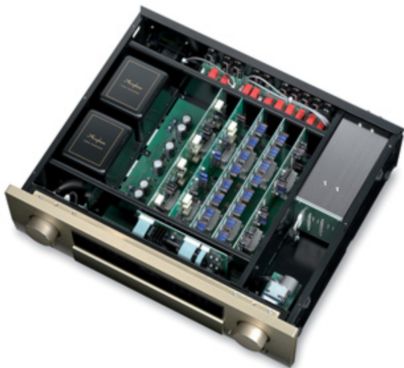
Im Abschirmkästchen rechts am Rand verrichten die optionalen Eingangsplatinen ihren Dienst, der Rest gehört AAVA
