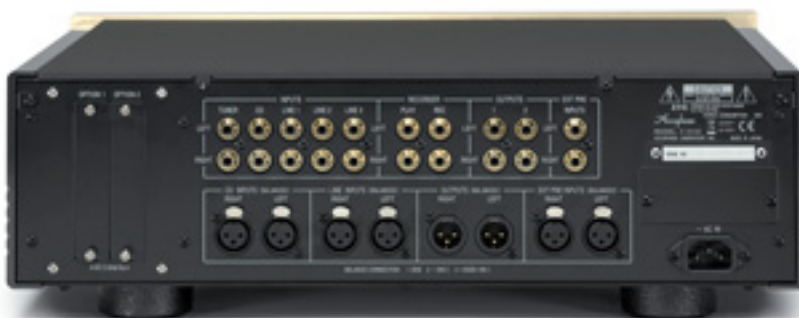
So muss die Rückseite eines Stereo-Steuerungscenters aussehen: klar gegliedert, opulent ausgestattet. Links harren zwei Steckplätze noch ihrer Bestückung
