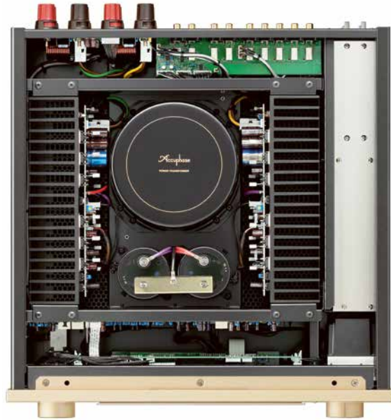
Auch der E-800 offenbart die für Accuphase typische Topologie mit zentralem Netzteil und Leistungselektronik an den Seiten. Der Metallschacht rechts schirmt die Module ab.
