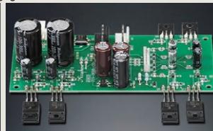
Eigene Stromversorgung für Signaleingangsstufe
