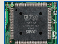
Digital signal-Processor (DSP) Chip mit Gleitkomma-Architektur
