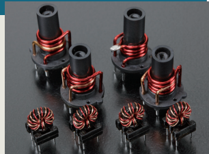
Dualstufen-Senderabstimmkreise mit Spulen
