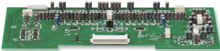
AAVA-Lautstärkeregelungs-Platine beseitigt Rauschen und andere Störungen
