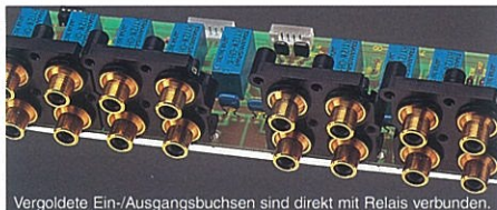
Vergoldete Ein-/Ausgangsbuchsen sind direkt mit Relais verbunden.
