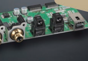
Baugruppe für sieben digitale Eingänge: HS-LINK, symmetrisch, koaxial (2), optisch (2), USB
