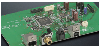
Baugruppe mit DAC und FPGA
