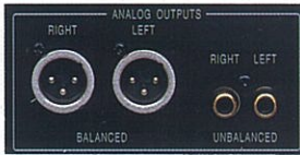
Analogausgang ist auch für symmetrische Kabelanschlüsse geeignet.
