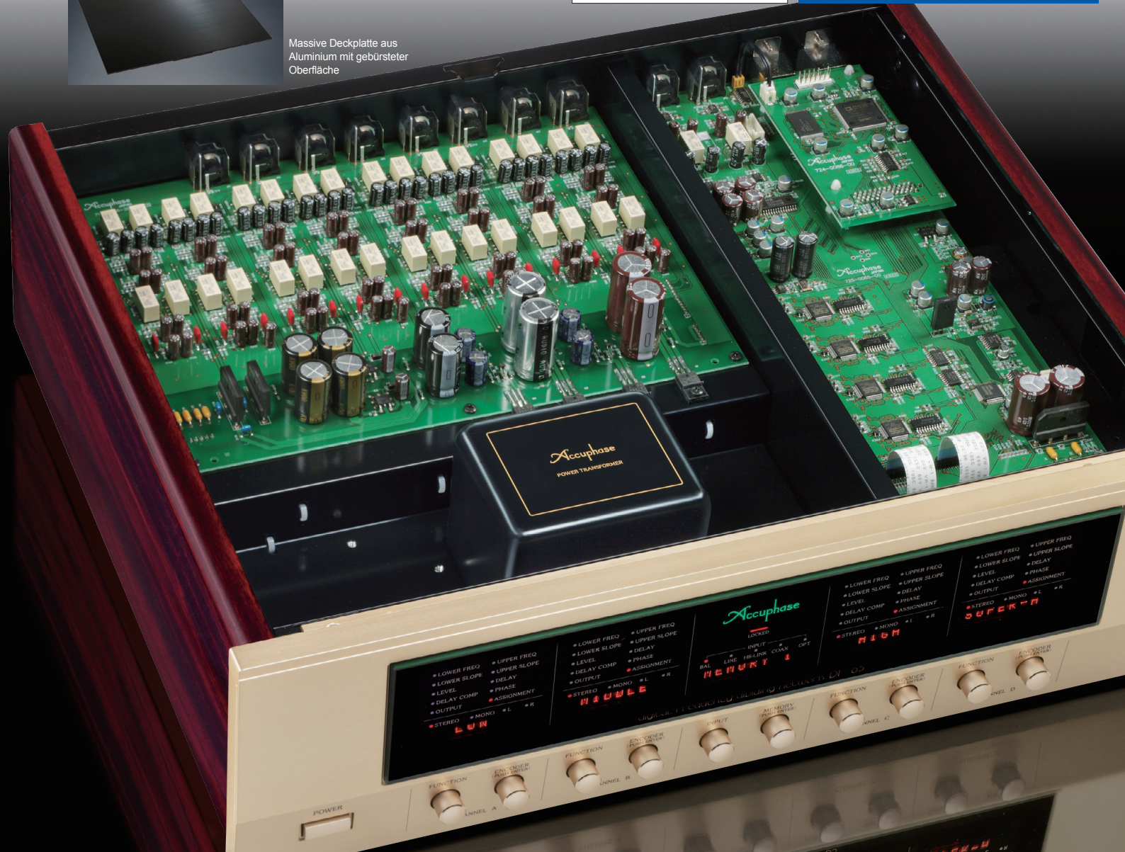
Hochgeschwindigkeits-DSP-Chip mit 40-Bit-Gleitkomma-Architektur
